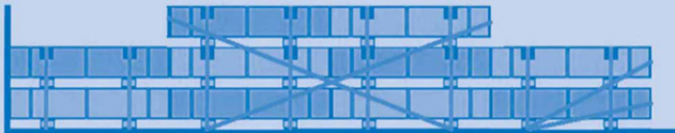
Рис. 1 Пример крепления от продольного смещения
